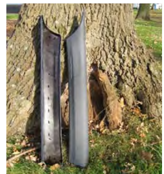
Natuurvezel versterkte PP autodeurpanelen met een toplaag van polyurethaan-
