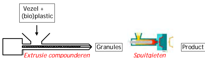
Schematische weergave van de productie en verwerking van spuitgietbare natuurvezel-versterkte plastic materialen.
