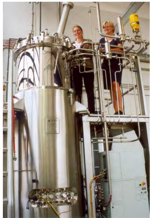
PHA's worden op pilot schaal gefabriceerd zoals hier bij Wageningen UR
