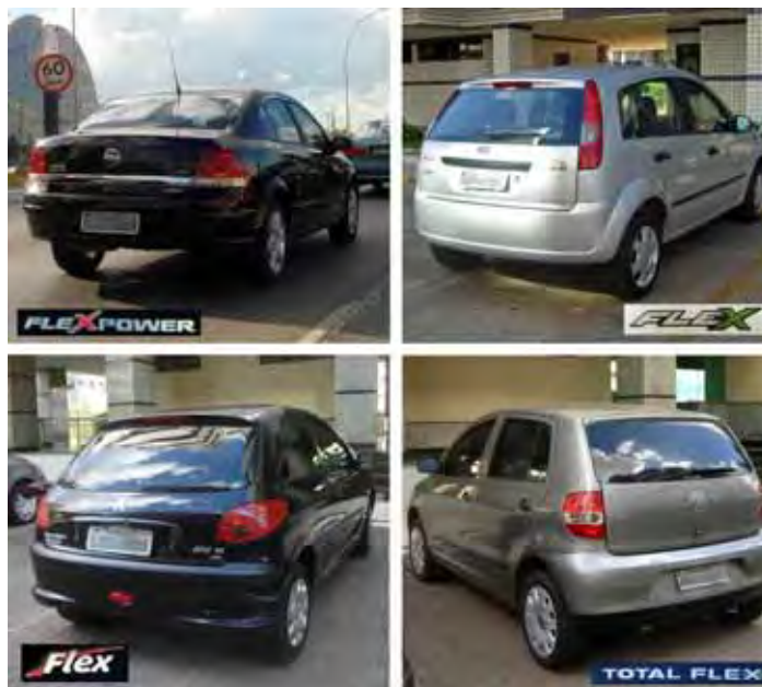
Figuur 2.8. Brazilië kent een flink aantal automodellen met flex-fuel motoren die op ethanol-benzine mengsels in verschillende verhoudingen, van pure benzine tot pure ethanol, kunnen rijden. (Bron: Mario Roberto Duran Ortiz).
